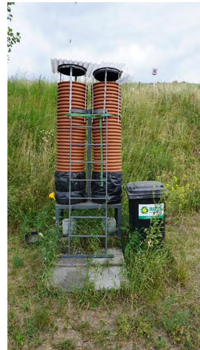
Stanowisko do badań lizymetrycznych przy składowisku odpadów komunalnych w Tychach | fot. Marek Softysiak
