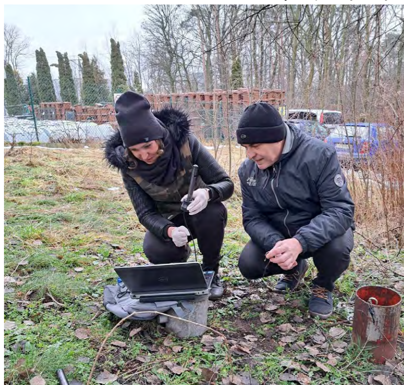
Pomiary terenowe przewodności elektrolitycznej właściwej z wykorzystaniem czujników | fot. Wojciech Rykała
